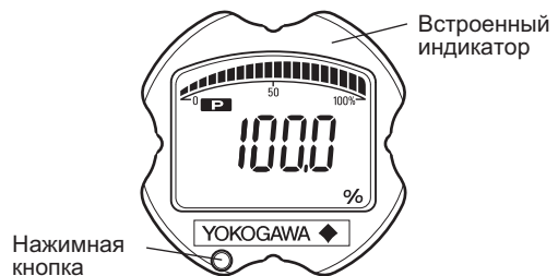
Рисунок 6.8 Переключатель установки диапазона (нажимная кнопка)
