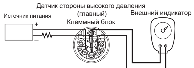
Рисунок 5.2 Подсоединение внешнего индикатора
