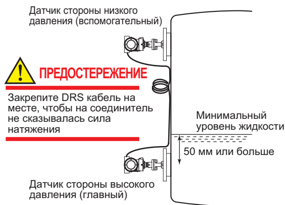
Рисунок 5.17 Крепление DRS- кабеля
