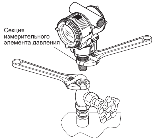
Рисунок 4.4 Затягивание соединения датчика
