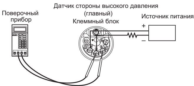
Рисунок 5.4 Подсоединение поверочного прибора
