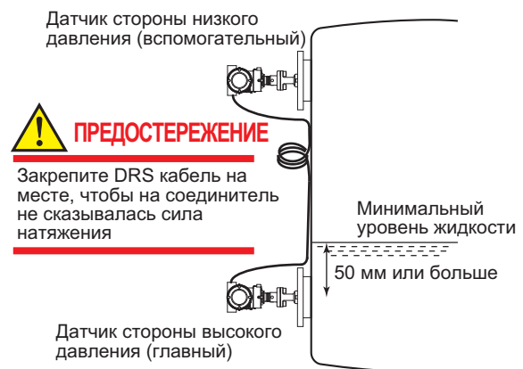
Рисунок 4.9 Пример монтажа на резервуаре
